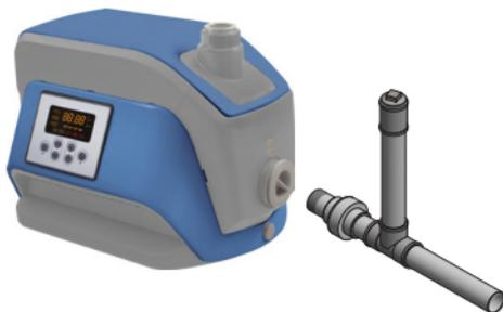
Si la bomba no será utilizada por un período largo de tiempo es conveniente desconectarla de la red eléctrica, drenarla completamente y limpiar el cuerpo. Recuerde utilizar un lugar seco, templado y a la sombra cuando la vuelva instalar. Antes de volverla a usar, quite la cubierta plástica del ventilador y hágala girar a mano, este debe girar libremente y sin atascamientos.
